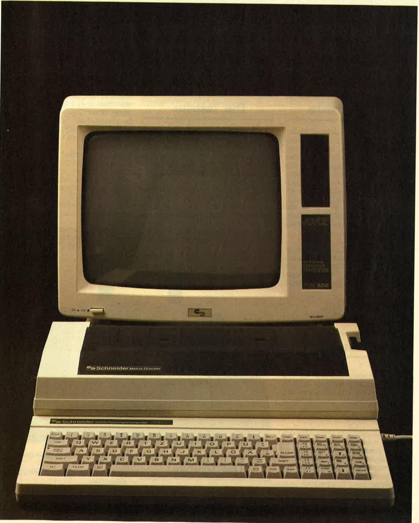
**Der neue Schneider Joyce ist ein Textverarbeitungssystem mit dem Betriebssystem CP/M Plus und 256 KByte Hauptspeicher. Im Lieferumfang enthalten sind die Sprachen BASIC und Logo sowie das Textverarbeitungsprogramm LocoScript.**
